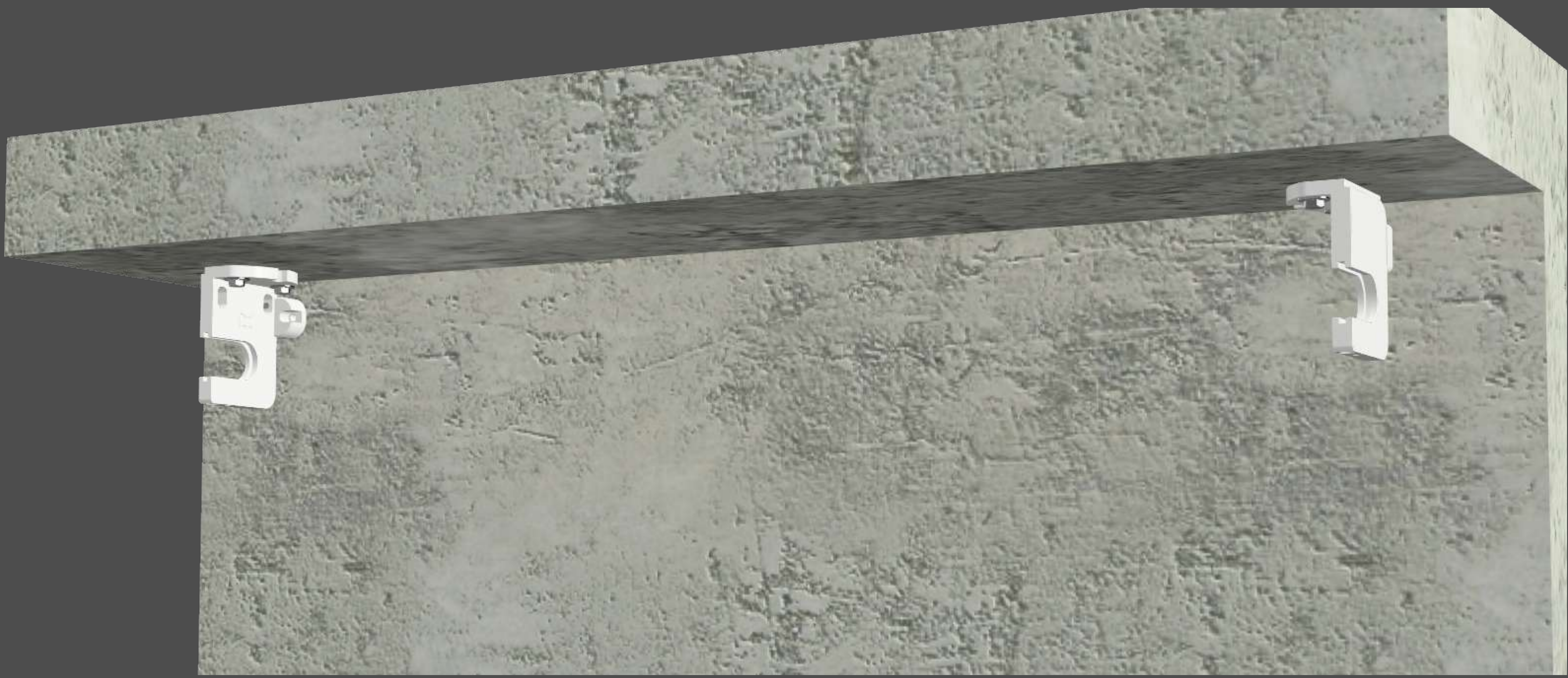
Colocar los soportes a nivel, como mínimo a 3cm de la pared con la base del tensor colocada si la lleva.
