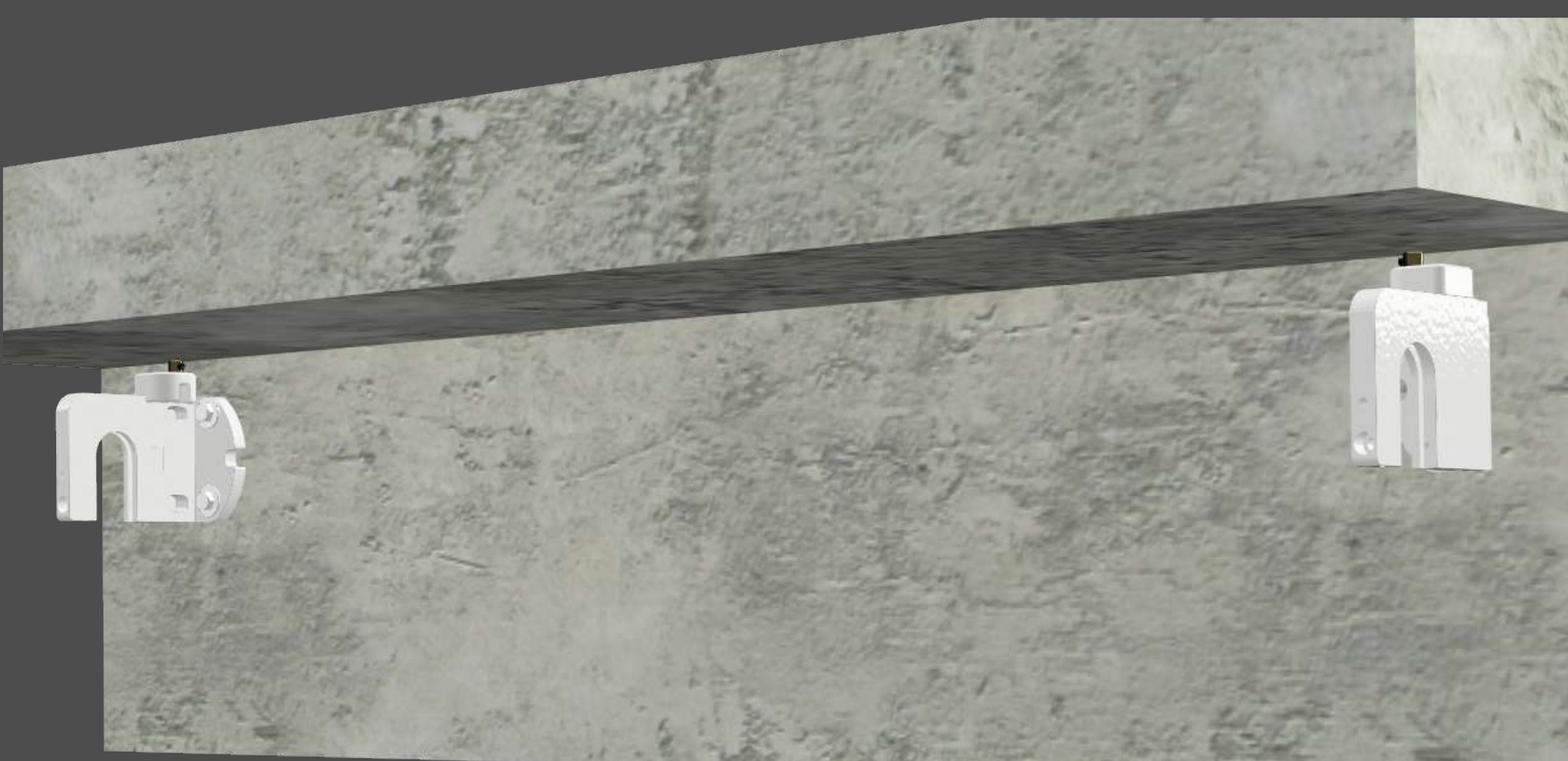
Colocar los soportes a nivel. Si lleva tensores poner la base del tensor previamente.
