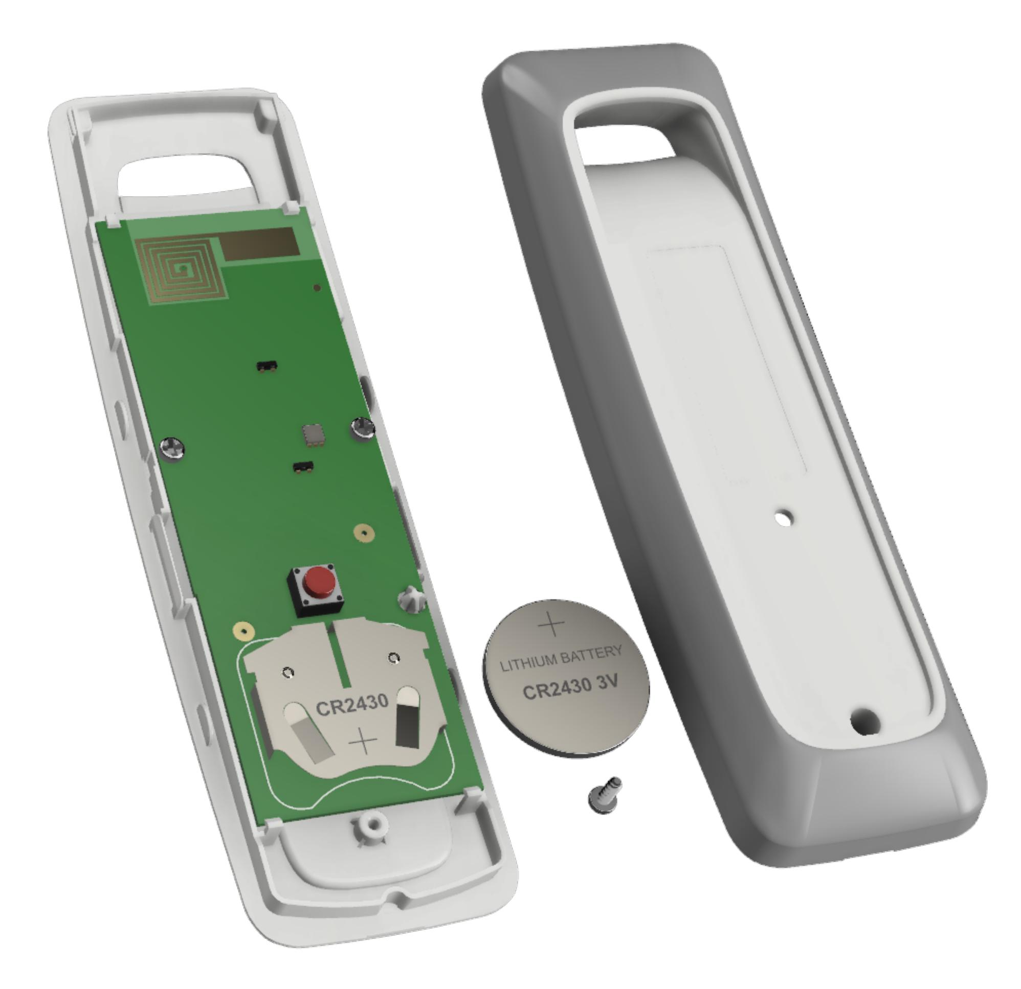
Sustituir la batería por una original, o el reemplazo comercial de idénticas características.
