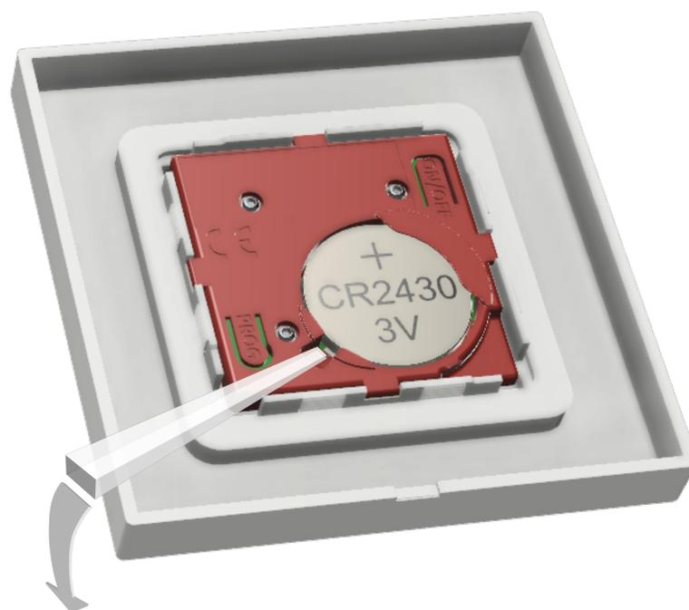
Sustituir la batería por una del mismo tipo, o el reemplazo comercial de idénticas características.
